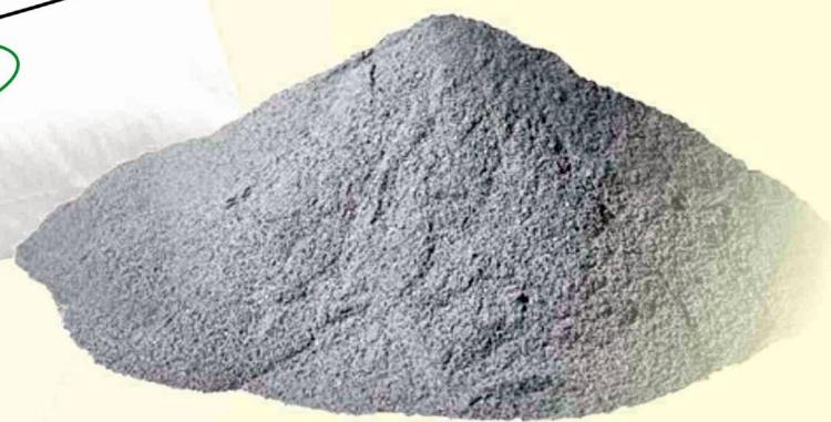
طی سالهای اخیر برای تامین سیستم ارت حفاظتی و الکتریکال تجهیزات و تاسیسات صنایع گوناگون ، مواد کاهنده با عنایت مختلفی برای تسريع عمل هدایت الکتریکی و درنهایت کاهش مقاومت الکترود زمین تولید شده است.
